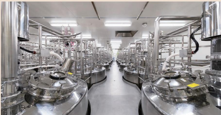
タンクでアイスクリームミックスの材料を混ぜ合わせ、均質化・殺菌した後、「エージングタンク」と呼ばれる巨大なタンクで温度を4℃まで下げて熟成させます。
