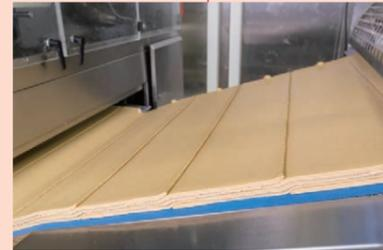
ローラーでシート状に伸ばした生地を何枚も重ねます。ビスケットに生地の層を作ることで、サクサクとしたソフトな食感が生まれます。
